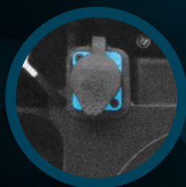
PROTECTION DES CONNECTEURS IP66
